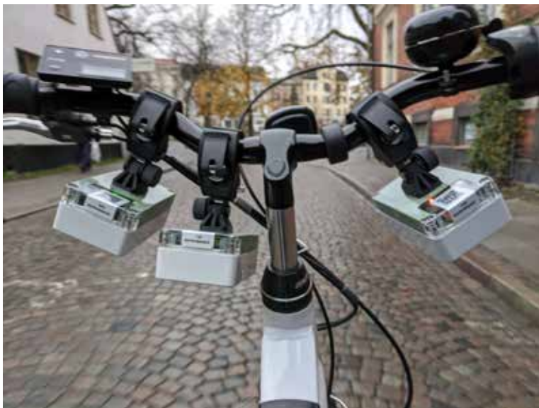
Sensorer på cykelstyre mäter luftkvalitet.
